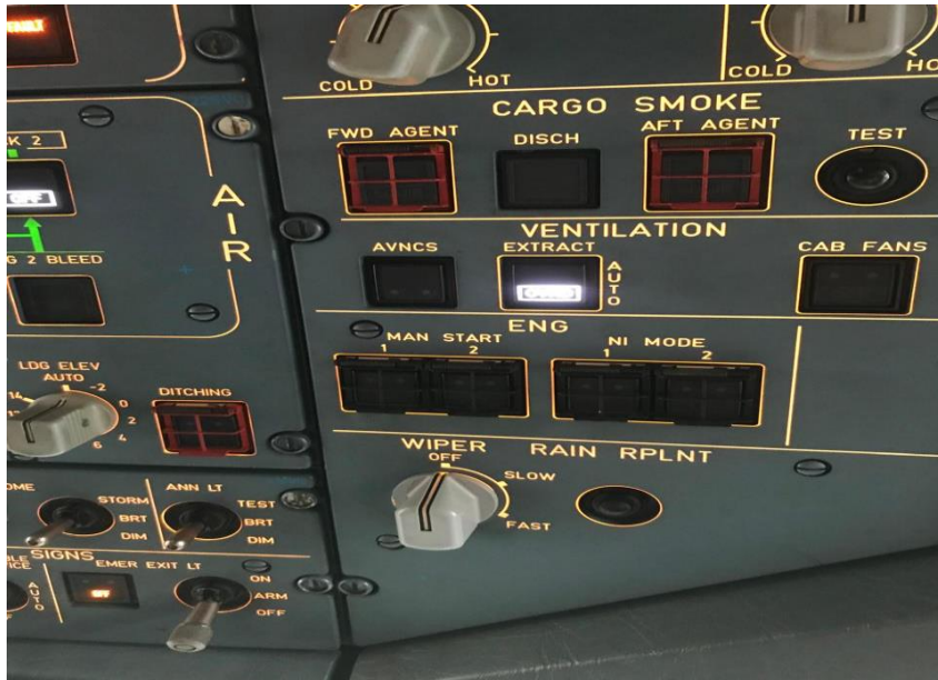
PANEL SWITCH FAN EXTRACT
