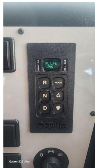
*Gambar 4. 6 Dokumentasi pengecekan kualitas oil life dengan indikator instrument display transmisi*
