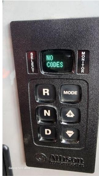
*Gambar 4. 19 Indikator display selector transmisi setelah dilakukan pembersihan dan pelumasan pada relay*
