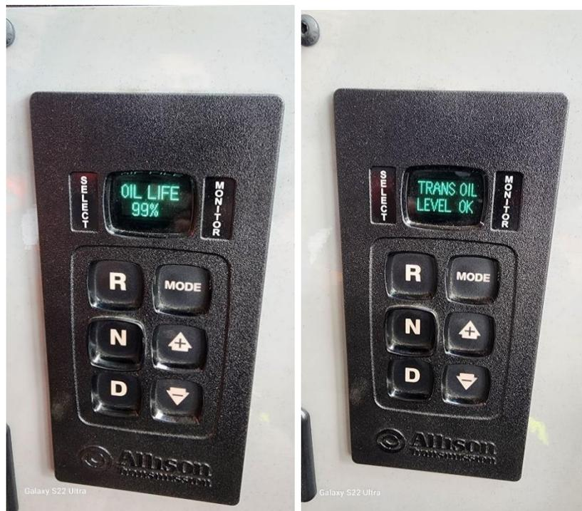
*Gambar 4. 9 Dokumentasi setelah dilakukan pengecekan dan penambahan level oli transmisi*
