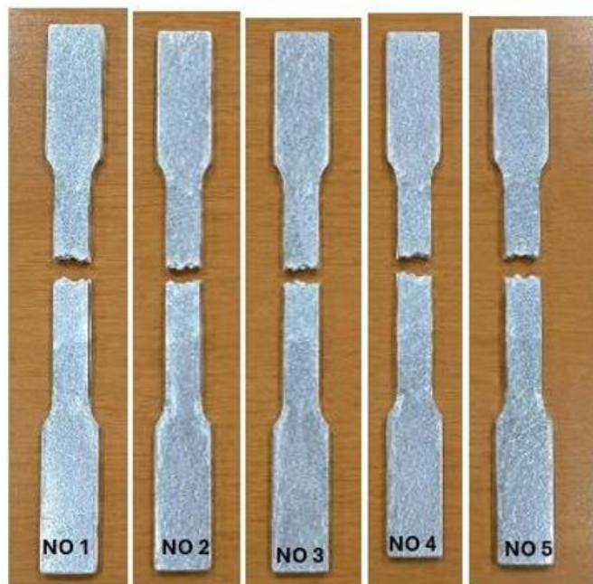
Gambar IV. 1 Spesimen Original Pasca Uji Tarik (Patah) (Sumber : Data Penulis)
