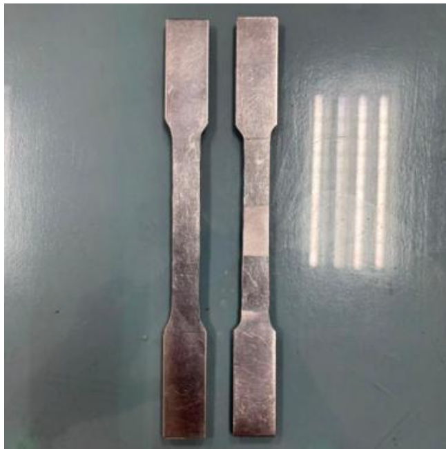
Gambar III. 2 Spesimen Uji Tarik Pasca Pemotongan (Sumber : Dokumentasi Pribadi)
