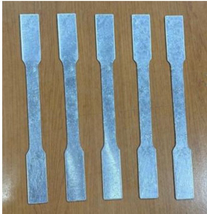
Gambar III. 3 Spesimen Original Pra Uji Tarik (Sumber : Dokumentasi Pribadi)
