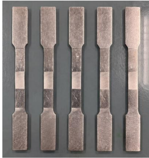
Gambar III. 4 Spesimen Blend-Out Pra Uji Tarik (Sumber : Dokumentasi Pribadi)
