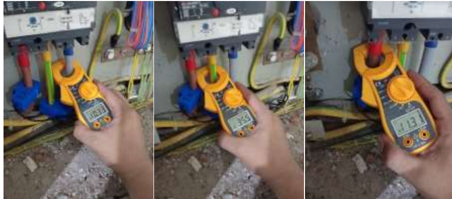
Gambar 4.15 Proses kalibrasi SCT-013 dengan tang ampere
