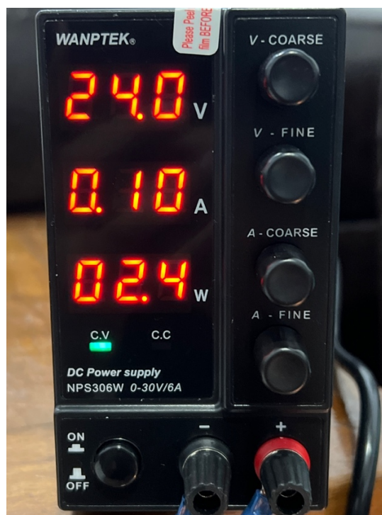
Gambar IV. 18 Hasil Arus Yang Dihasilkan Dengan 1 lampu (Sumber: Data Pribadi)
