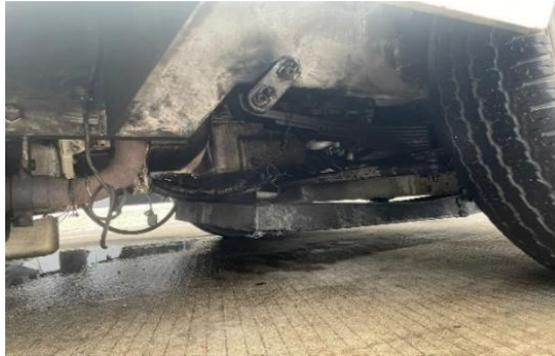
**Gambar 4. 2 Rem Blong dan Kebocoran Oli**
