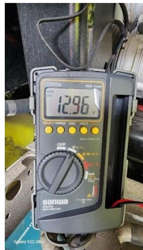
Gambar 4. 15 Dokumentasi pengukuran tegangan pada battery
