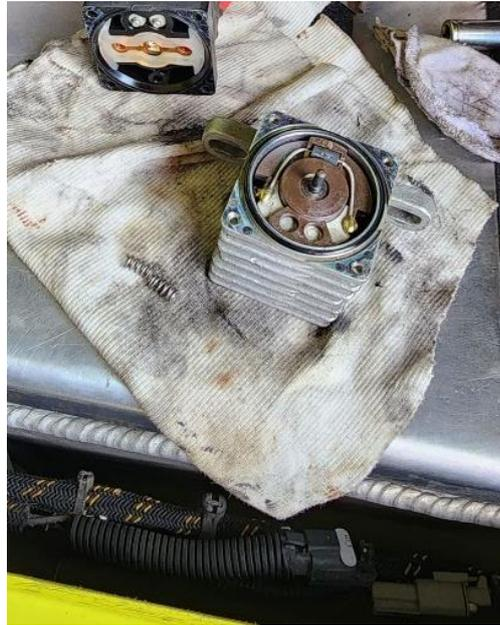
*Gambar 4. 18 Dokumentasi pembersihan dan pelumasan pada relay*
