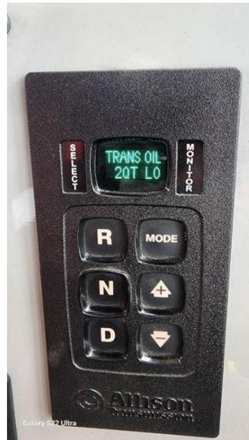
*Gambar 4. 7 Tampilan indikator display level oli transmisi sebelum dilakukan penambahan oli*
